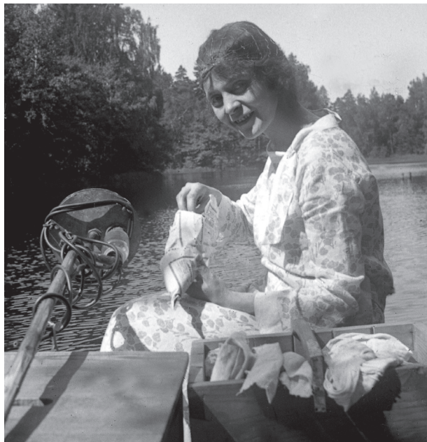
Рис. 2. Л.П. Рылова за взятием проб на пруду (Петергоф, 1926 г.). Слева на фотографии виден илосос Б.В. Перфильева, пробоотборник для сбора донных осадков (Перфильев, 1927, с. 138)
