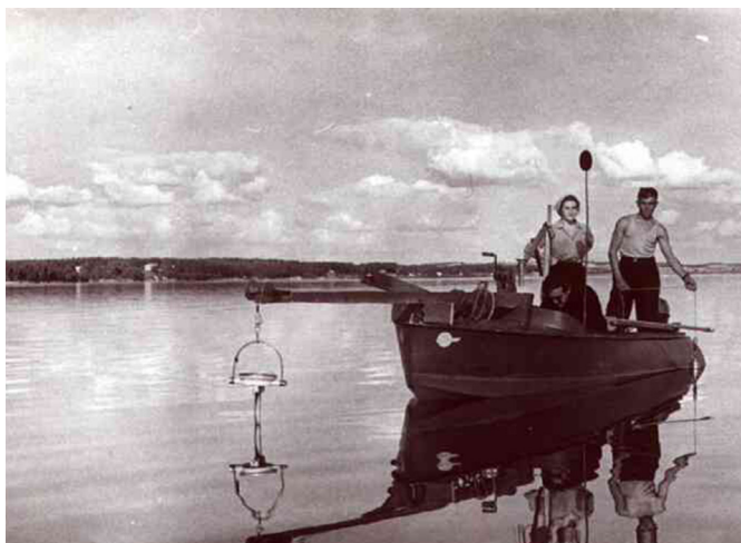
Рис. 5. Измерение падающей и подводной солнечной радиации. Оз. Нарочь, 1961 г.
