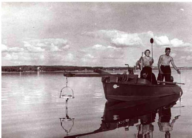
Рис. 5. Измерение падающей и подводной солнечной радиации. Оз. Нарочь, 1961 г.
