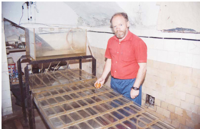
Рис. 7б. Сотрудник лаборатории экспериментальной эмбриологии (цитологии) Юрий Николаевич Городилов у созданной им установки для культивирования икры рыб в контролируемых температурных режимах. Подвал дворца герцогов Лейхтенбергских, Петергоф, усадьба Сергиевка, 1991 г.
